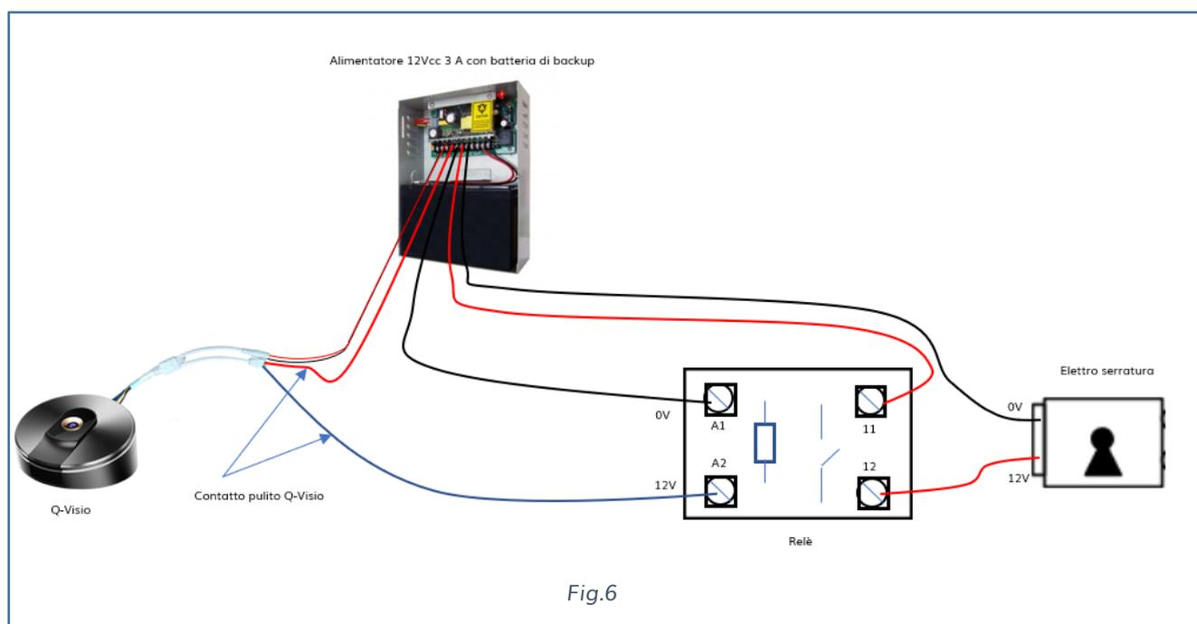
**IMPORTANTE:** per il collegamento con elettro serrature o sirene, collegare il dispositivo ad un relè esterno adeguato, e non direttamente all'impianto.
